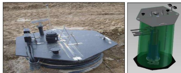
Figure 24 : puits à condensats
